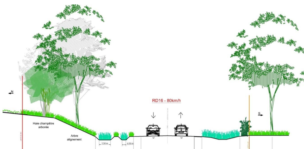
Principe d'aménagement de la voie primaire limitée à 80 km/h (déviation de la RD 16).
